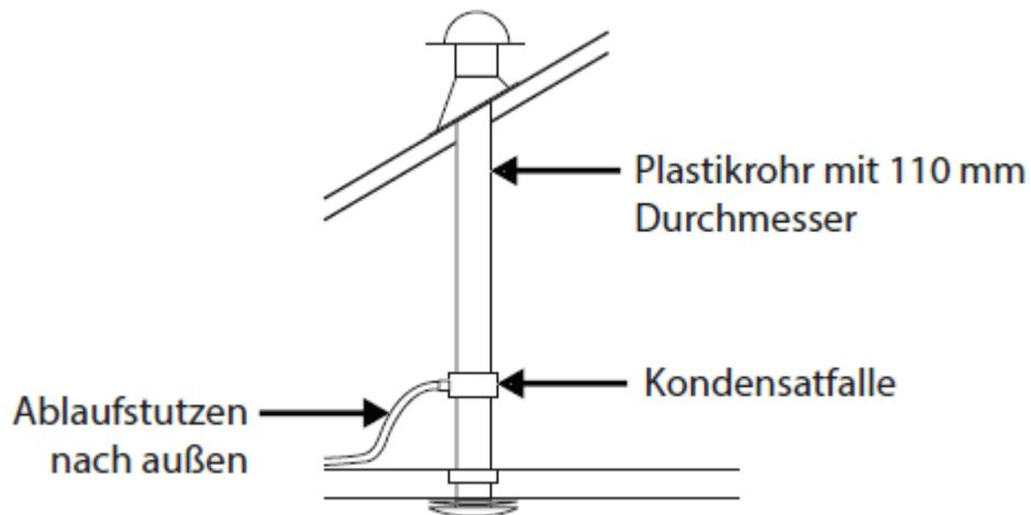
Um bei Deckeninstallationen einen Rückfluss von Kondensat in den Lüfter zu vermeiden, ist zu empfehlen, eine Kondensatfalle (optional - Art.: 72042) in den vertikalen Bereich der Lüfterausgangsleitung zu montieren.
