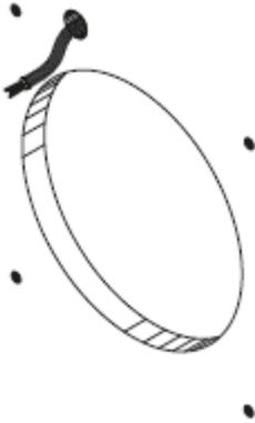
Der Lüfter wird über das Abluftrohr montiert. Stellen Sie sicher, dass das Kabel durch die mitgelieferte Kabeltülle geführt wird. Richten Sie den Ausrichtungspfeil vertikal aus. Mit den 4 mitgelieferten Schrauben befestigen Sie das Gerät an der Wand oder Decke.
