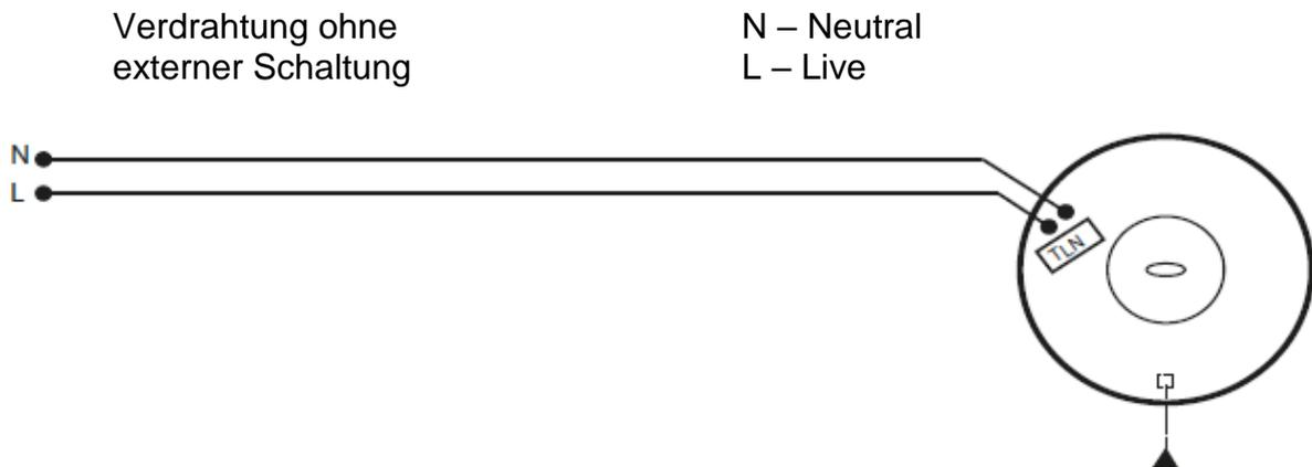
Alle elektrischen Installationen sollten von einem zugelassenen Elektroinstallateur gemäß VDE 0100 erfolgen. iCONstant-Lüfter erfordern eine 90-264V 50/60Hz-Spannungsversorgung. Diese sind schutzisoliert, so dass keine Erdung erforderlich ist und sind in Schutzzone 2 und 3 zu installieren. In Schutzzone 1 montierte Lüfter müssen über eine Schutzkleinspannungs-Klasse verfügen. Das iCONstant-Sortiment entspricht Schutzklasse IPX5 (strahlwassergeschützt).
