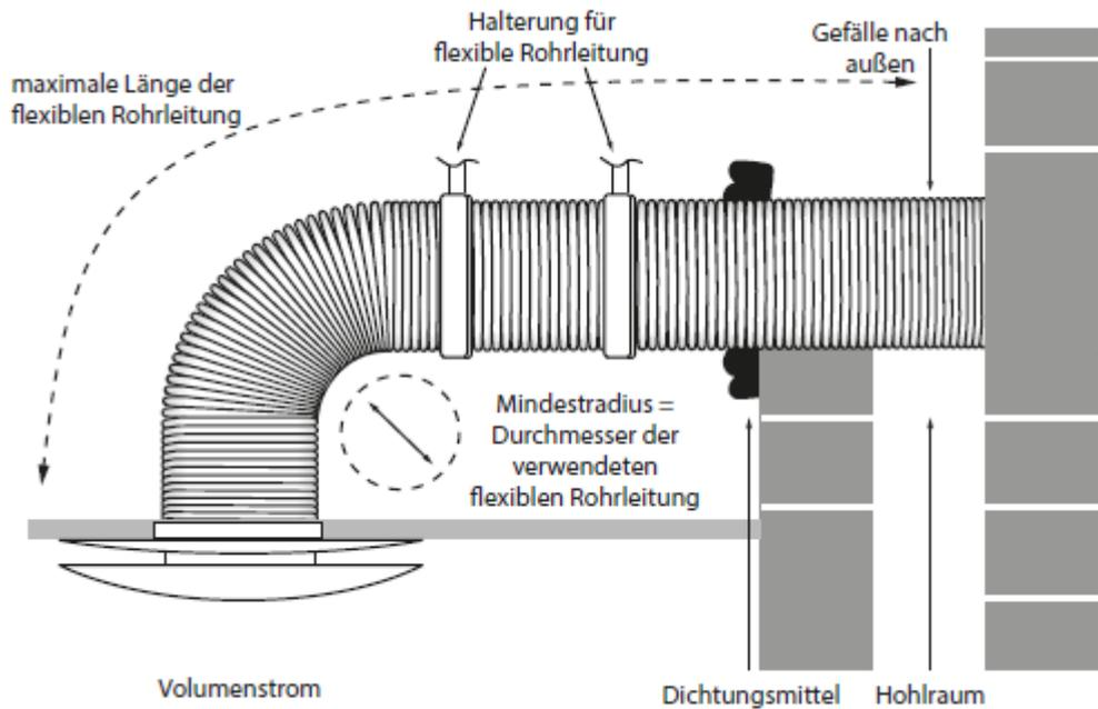
Bei Verwendung einer flexiblen Luftleitung darf sich der Durchmesser nicht verringern, und im Hinblick auf die Lüftung empfiehlt sich, die Leitung höchstens auf 90 % ihrer maximal möglichen Länge zu verlängern, um so den bestmöglichen Luftstrom zu erhalten. Stellen Sie sicher, dass die flexible Luftleitungsanschlüsse nicht übermäßig am Abluftrohrstutzen festgezogen werden.
