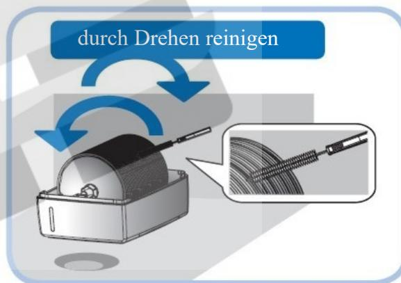
Den Wasserbehälter mit Wasser und Reinigungsmittel bis zur Markierung des maximalen Wasserstandes füllen. Durch Drehen und mit der mitgelieferten Bürste die rotierende Walze reinigen.
